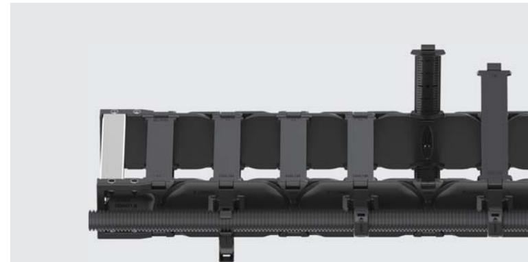
TriCross 系列拖链内外表面极其圆润光滑，得益于链节三点交叉支撑设计，兼具高承载和轻自重。铰链式横杆可快速打开和闭合，方便填装各类管线，是高性价之选。
