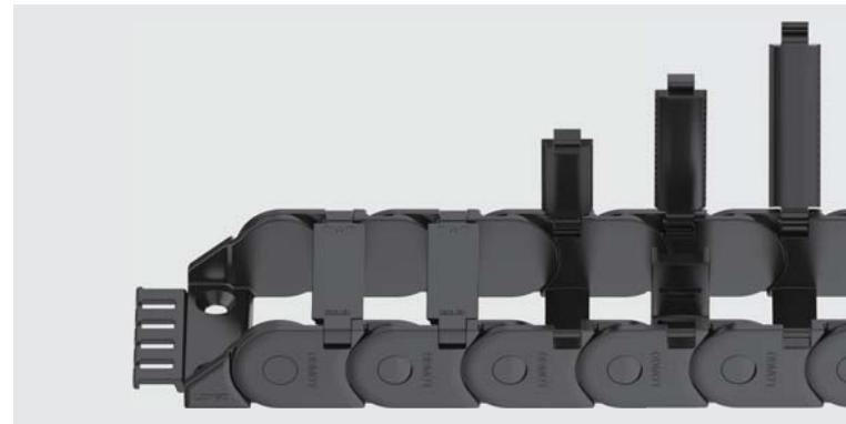
EasyClip mini系列拖链适用于低负载或小空间的应用。小节距，运行顺畅且噪音低。借助可打开的铰链式横杆，可方便快速地填装电缆和软管。
